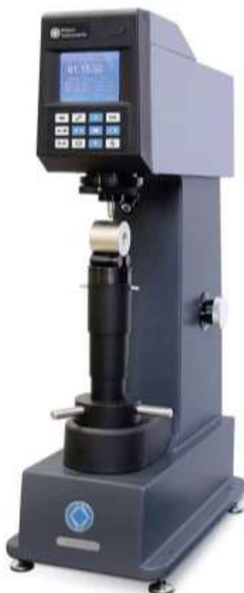
Figura 2: Durômetro Wilson Hardness Rockwell 574.
