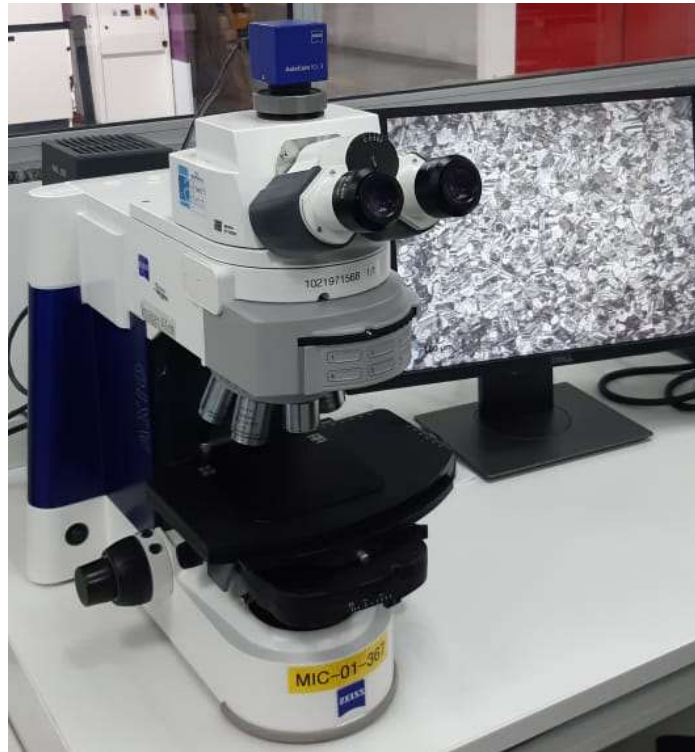
Figura 6: Microscópio Óptico Zeiss Imager A1m.
