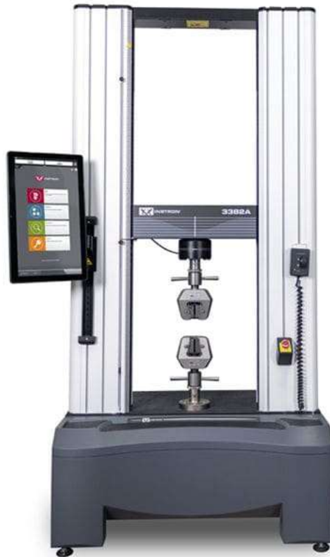
Figura 3: Máquina Universal de Ensaio Instron 3382.
