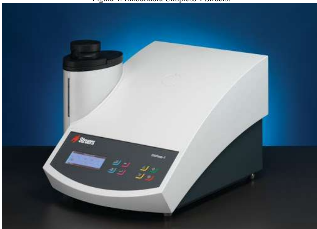
Figura 4: Embutidora Citopress-1 Struers.
