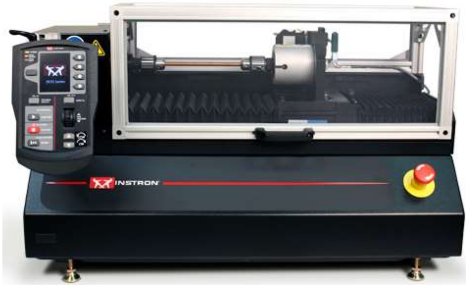
Figura 7: Máquina Ensaio Torcional Instron.
