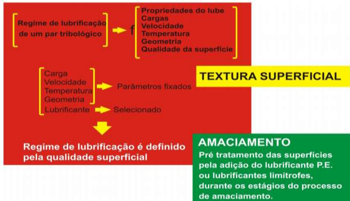
Figura 5 – esquema para auxiliar a escolha do regime de lubrificação
