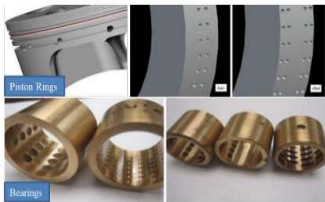
Figura 7: técnicas de texturização em superfícies em anéis e mancais de pistão
